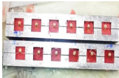
شکل ۲: مانت نمونه‌ها در آکريل
