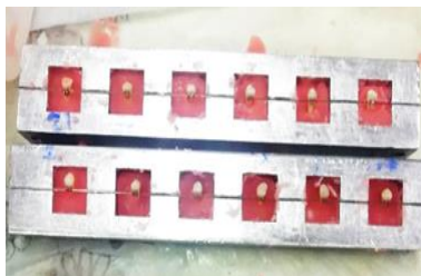
شکل ۲: مانت نمونه‌ها در آکریل
