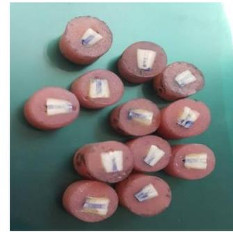
شکل ۳: نمونه‌های مانت شده جهت انجام تست میکروهاردنس
