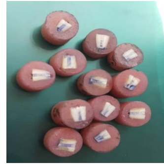
شکل ۳: نمونه‌های مانت شده جهت انجام تست میکروهاردنس
