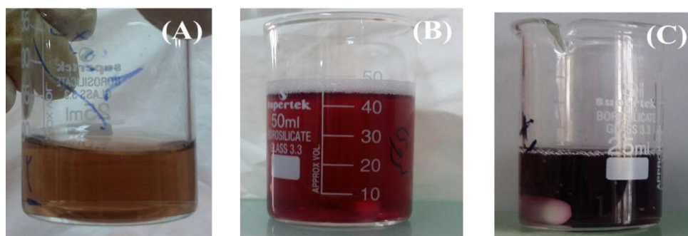
شکل ۱: تغییر رنگ محلول‌های حاوی نانوذرات طلا (A) محلول seed (B) نانوذرات کروی (C) نانوذرات میله‌ای
