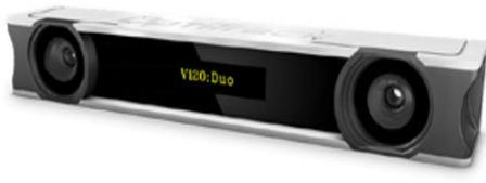
شکل ۲: دوربین سه بعدی Optitrack
