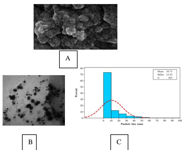
شکل ۲: نتایج میکروسکوپ الکترونی SEM (A) TEM (B) و نمودار میانگین سایز نانوذرات (C). با توجه به نمودار اندازه تفریبی سایز نانوذرات نقره  $10.71 \pm 13.93$  نانومتر بود.
