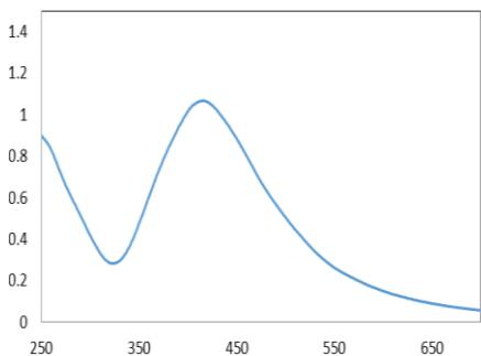
شکل ۱: طیف سنجی UV-Vis نانوذرات نقره سنتز شده. با توجه به شکل، جذب UV نانوذرات نقره سنتز شده در طول موج بین  $250^{\circ}$  تا  $700$  نانومتر خوانده شد و ماکریم جذب در طول موج  $438$  نانومتر بود.
