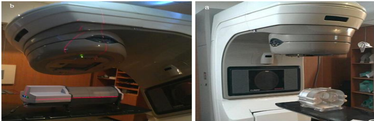
شکل ۴: (a) فیلم داخل فانتوم ناهمگن و (b) فانتوم Delta4
