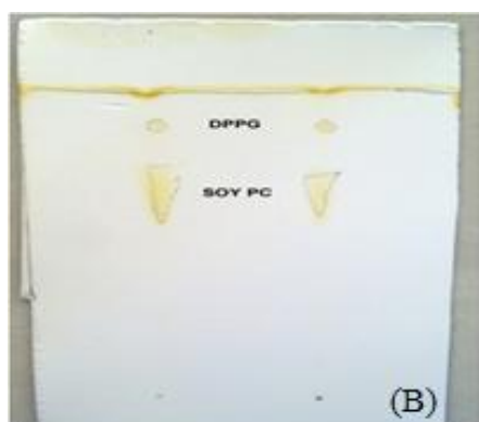
نمودار ۵: سمت راست (A) آنالیز FTIR نمونه نانولیپوزومی خشک شده با فرمولاسیون (SOY PC:DPPG:CHOL:mPEG2000-DSPE). شکل سمت چپ (B) نمایی از پیشرفت حلال بر روی کاغذ TLC توسط واکنش گریداین بعد از انحلال فسفولیپیدهای موجود در نمونه
