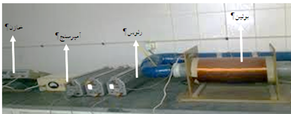
شکل ۱: سیستم انکوباسیون جوجه همراه با دستگاه مولد میدان الکترومغناطیس با فرکانس کم (طراحی شده در مرکز تحقیقاتی بیولوژی کاربردی تکونری جانوری)
