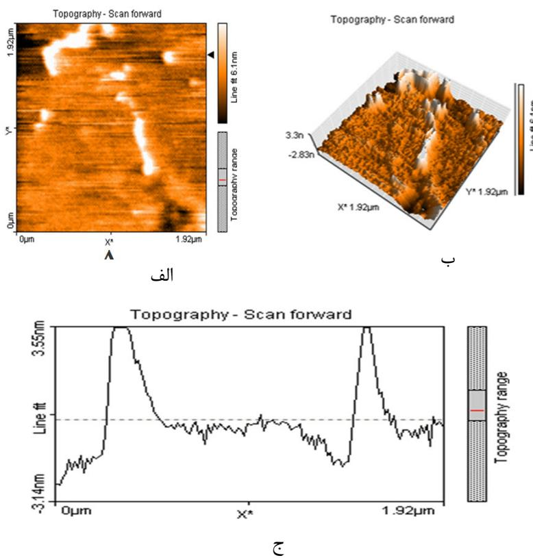
شکل ۱: تصویر نانو ذره نقره ۷۰ مورد استفاده در این آزمایش توسط میکروسکوپ AFM
