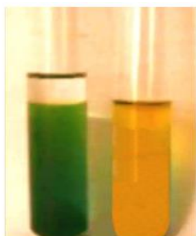
شکل ۱۵: نتایج تست مصرف گلوکز توسط باکتری P. butanolivorans KG سمت راست (اکسیداتیو) و سمت چپ (تخمیری)
