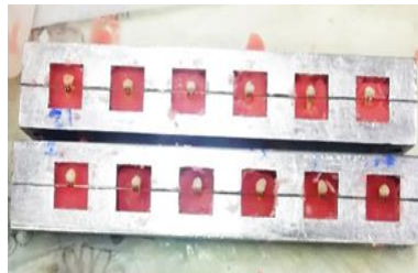
شکل ۲: مانت نمونه‌ها در آکريل
