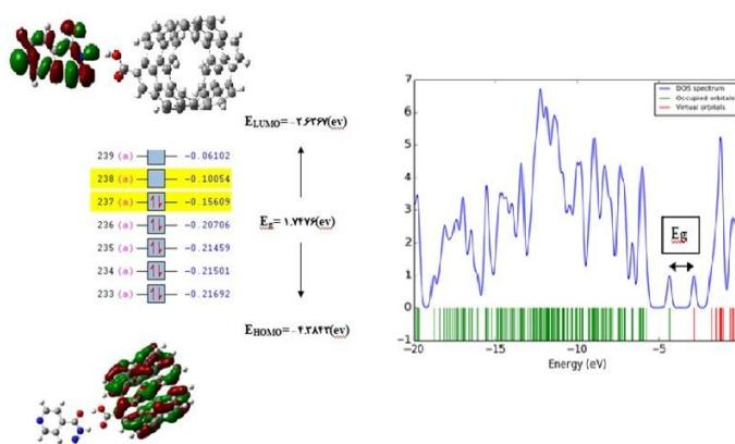
شکل ۴: دیاگرام اوربیتال مولکولی هومو و لومو و نمودار DOS برای کمپلکس ایزونیازید - نانولوله کربنی عامل‌دار
