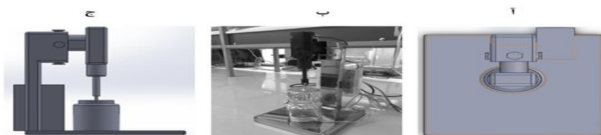
شکل ۷: راه اندازی دستگاه اعمال بار مکانیکی، (آ) شماتیک نمای بالا، (ب) تصویر اصلی بیوراکتور و (ج) شماتیک نمای جانبی
