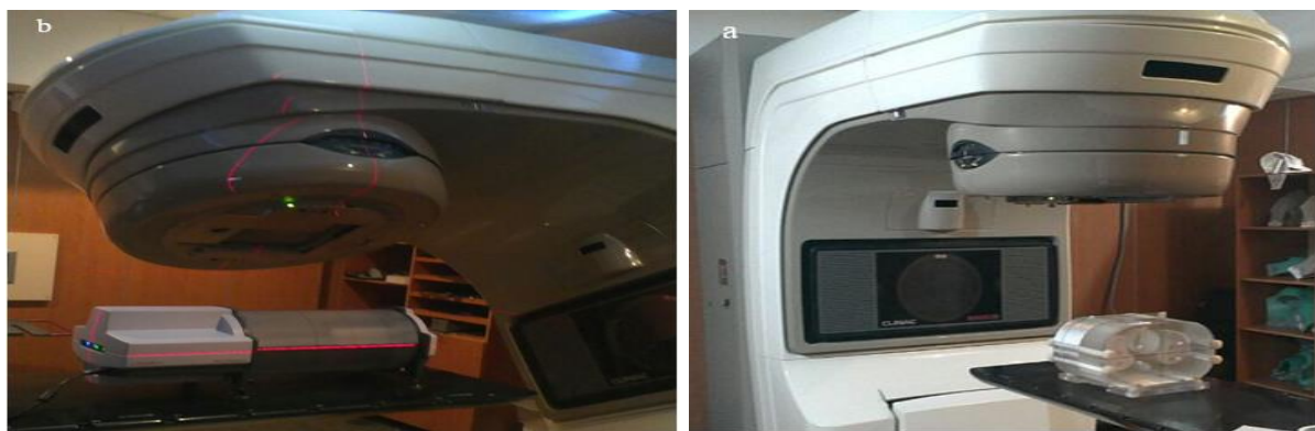
شکل ۴: (a) فیلم داخل فانتوم ناهمگن و (b) فانتوم Delta4
