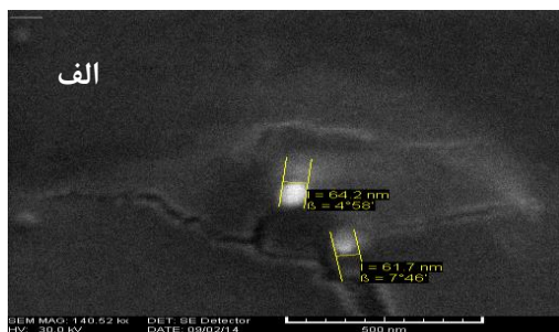
شکل ۴: تصاویر SEM نانوذرات نشاسته بارگذاری شده با کارکامین (الف) بزرگنمایی ۱۰۰ نانومتر (ب) بزرگنمایی ۱۰۰۰ نانومتر
