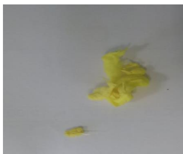
شکل ۶: پودر نانوذرات نشاسته‌ای بارگذاری شده با کارکامین تهیه شده با روش خشک کردن انجمادی.
