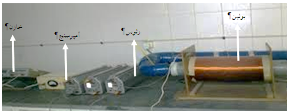
شکل ۱: سیستم انکوباسیون جوجه همراه با دستگاه مولد میدان الکترومغناطیس با فرکانس کم (طراحی شده در مرکز تحقیقاتی بیولوژی کاربردی تکوین جانوری)
