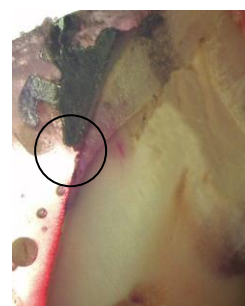
تصویر ۴: نمونه‌ای از ریزش رتبه ۳ در براکت فلزی
