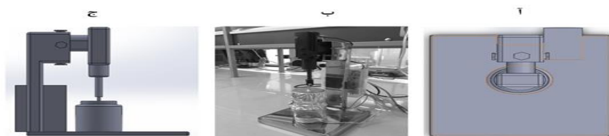
شکل ۷: راه اندازی دستگاه اعمال بار مکانیکی، (آ) شماتیک نمای بالا، (ب) تصویر اصلی بیورآکتور و (ج) شماتیک نمای جانبی
